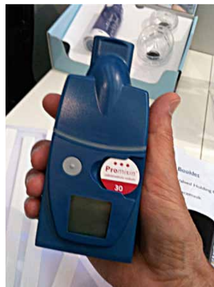
Nebulizzatore con meccanismo Adaptive Aerosol Delivery con static mesh (I-neb®, Philips Respironics).
